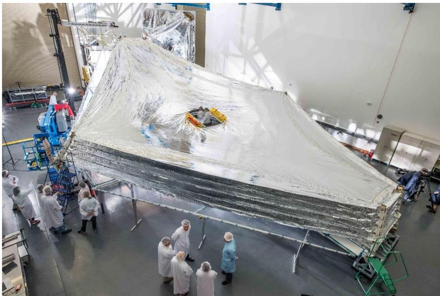
Abbildung 1: Der Sonnenschutzschild des James-Webb-Weltraumteleskops [Quelle: NASA]
